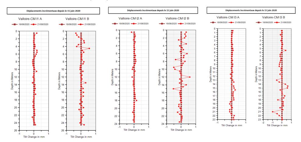
On constate que les variations angulaires se retrouvent sensiblement toute hauteur et de part et d'autre de l'axe vertical II n'y a donc pas de plans ou zones de glissement ou même de fluage identifiable sur le versant considéré.
